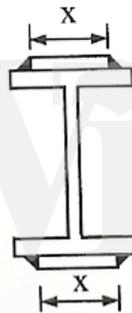
鋼板補強示意圖
